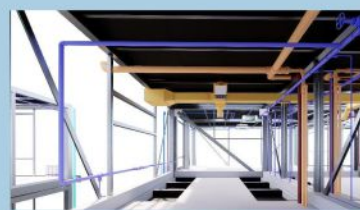
小学走廊管综
